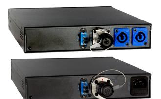
PS-AC100复合光缆供电单元体积小巧,可通过长至 1公里的SMPTE规格复合光缆,提供两路总共100W 的交流供电输出. 同时带有短路保护和负载功率检 测及指示功能,可在各种现场制作环境下满足高效 安全的供电需求。
