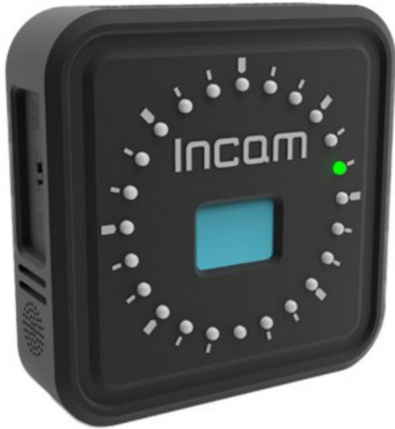
LSC-1声画同步校准工具是一款广播级音视频同步检测及校准装置，采用高亮度发光二极管和精密压电扬声器作为精确视频源和音频源，铝合金外壳坚固耐用，内置锂电池实现超长工作时间，可满足各种演播室及外场转播条件下的声画同步和唇同步的检测及校准需求。
